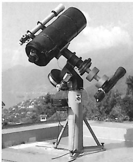
Il telescopio Maksutov \varnothing 300 mm f=4800 mm della SAT, installato sulla terrazza del celostato alla Specola Solare di Locarno.
