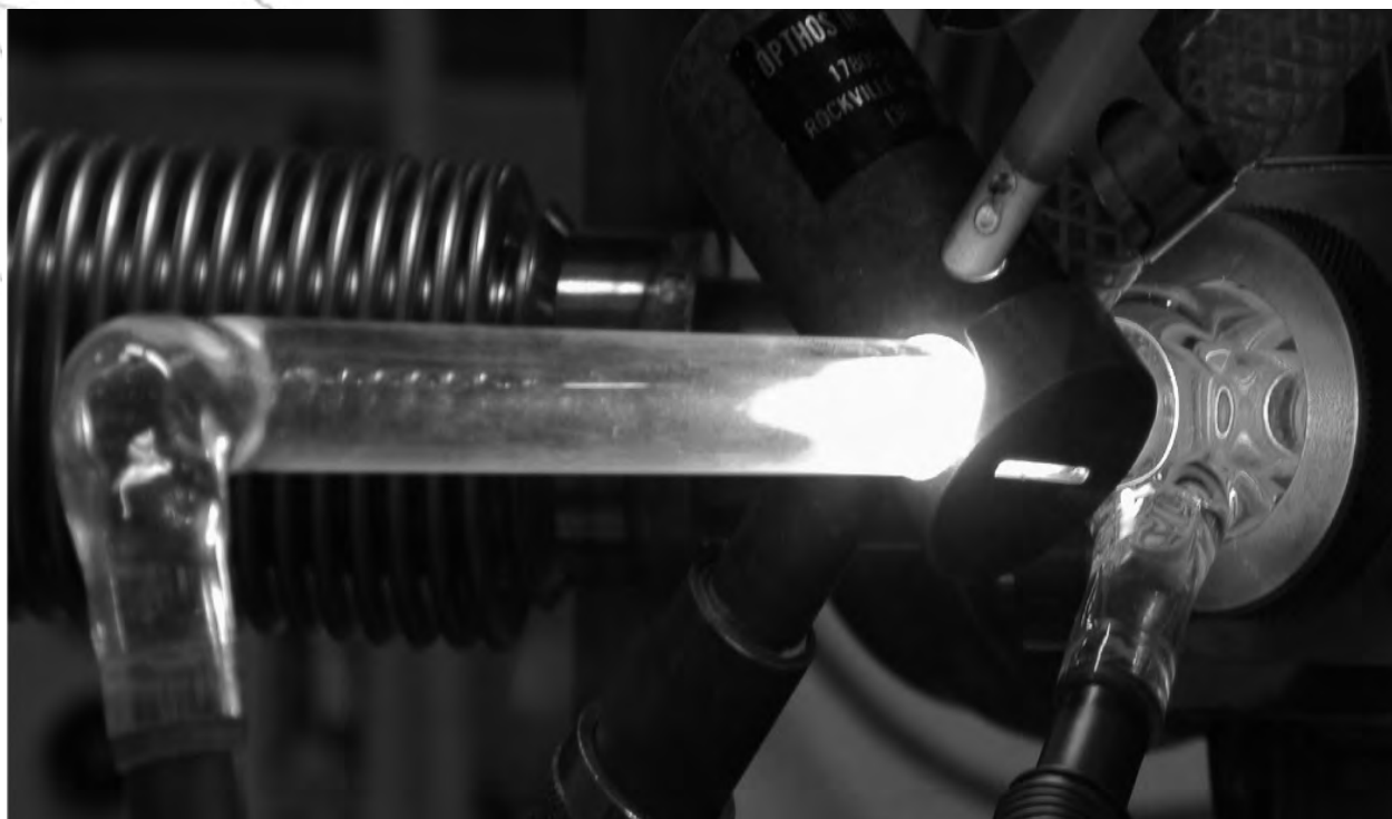
I fotoni ultravioletti, bombardando un campione di ghiaccio a -263 gradi, inducono la rottura dei legami chimici e la formazione di composti complessi, come l'uracile.
