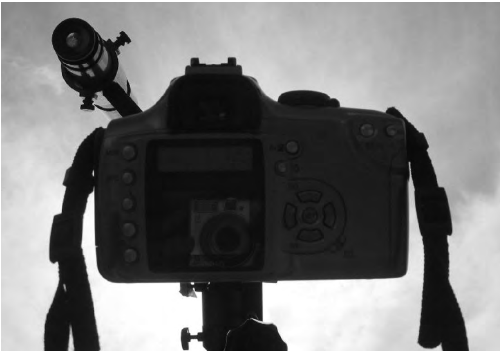
La «vista» della fotocamera come appare a un osservatore che sta per scattare una foto del Sole con il rifrattore 90/1000 al fuoco diretto del telescopio. La stella è nascosta dalla fotocamera.
