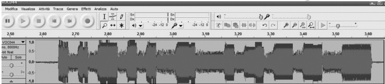
Traccia sonora con Audacity del primo segnale orario RAI lungo 96 centesimi di secondo e trasmesso al 52.esimo secondo, che porta codificata l'informazione di 32 bit dell'ora e del minuto.
