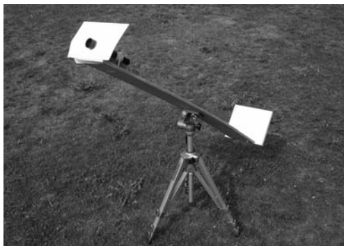
ll'estremo superiore dell'asse, il cannocchiale 8x30. Lo schermo all'estremo opposto
