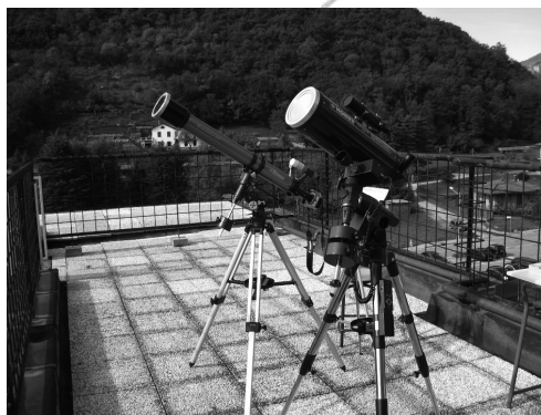
Il Riflettore Maksutov - Cassegrain da 150/1800 ed il Rifrattore da 90/1000, con filtri solari in Mylar a tutta apertura, posizionati sulla terrazza del sito di osservazione dell'attore, presso l'ISIS "Valceresio" di Bisuschio.
