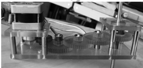
Dettaglio del motorino AR "passo-passo" con gli'ingranaggi riduttori.
