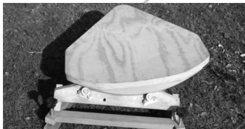
La piattaforma equatoriale con il piano di appoggio in legno.
